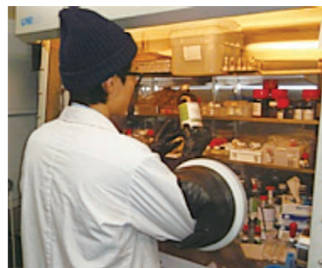
■グローブボックス等を活用した不活性ガス雰囲気下での実験を駆使して、空気・水に対し不安定な化合物でさえも自在に合成します。 Highly air- and/or moisture sensitive compounds can be handled in the glove box.
